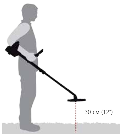
Рисунок 17 – Правильное положение детектора для отстройки от помех
